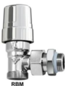
Корпус из хромированной латуни. Штуцер с двумя уплотнениями. Уплотнения из этилен-пропилена (EPDM) и нитрильного эластомера (NBR). Ручка из ударопрочного ABS. Угловое соединение, резьба Вн. UNI-EN-ISO 228 для медных или полиэтиленовых труб. Резьбовое соединение с радиатором UNI-EN-ISO 228 Нар. с тефлоновым уплотнением (PTFE).
