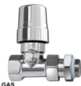
Корпус из хромированной латуни. Штуцер с двумя уплотнениями. Уплотнения из этилен-пропилена (EPDM) и нитрильного эластомера (NBR). Ручка из ударопрочного ABS. Прямое соединение, резьба Вн. UNI-EN-ISO 228 для железных труб. Резьбовое соединение с радиатором UNI-EN-ISO 228 Нар. с тефлоновым уплотнением (PTFE).
