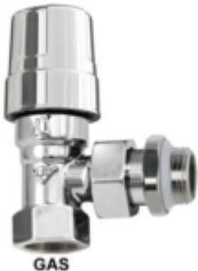
Корпус из хромированной латуни. Штуцер с двумя уплотнениями. Уплотнения из этилен-пропилена (EPDM) и нитрильного эластомера (NBR). Ручка из ударопрочного ABS. Угловое соединение, резьба Вн. UNI-EN-ISO 228 для железных труб. Резьбовое соединение с радиатором UNI-EN-ISO 228 Нар. с тефлоновым уплотнением (PTFE).
